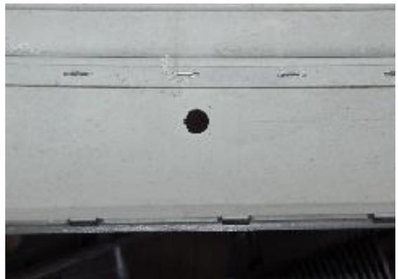
Nach dem Aufbohren die Löcher mit feinem Schleifpapier nacharbeiten.
