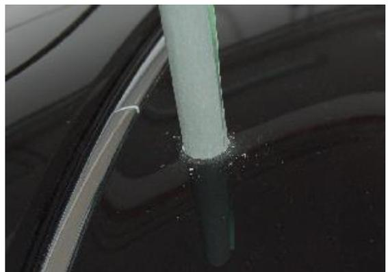
**Vor dem Kleben der Sensorhalter die Klebefläche gründlich reinigen bzw. anschleifen.
