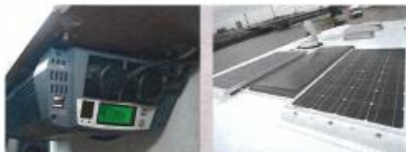
KRAFTSTATION Der Wechselrichter (links) stellt den Strom der Solarpaneele (Dach) im Fahrzeug zur Verfügung und lädt die Aufbau-Batterie
