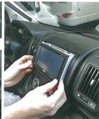
Die Geräte verschwinden fast komplett in der Mittelkonsole, auf die noch ein Rahmen gesetzt wird.
