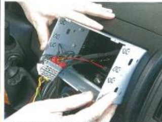
Der Einbauschacht ist bei allen Geräten gleich. Nach Fahrzeug braucht es unterschiedliche Blenden.
