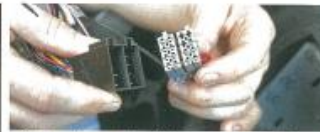
Über den Hauptstecker wird der Naviceiver mit allen wichtigen Anschlüssen des Fahrzeugs verbunden.
