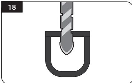
Ein 35 mm Loch (oder größer) in der Mitte des Klebebandes bohren
