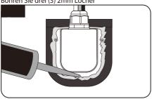
Tragen Sie Silikon rund Kabelhalter und auf der Oberseite der Schrauben für wasserdichte
