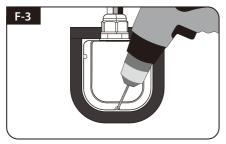
Legen Sie und halten Sie die montierten Kabelhalter im Inneren der Bandmarkierungen. Bohren Sie drei (3) 2mm Löcher
