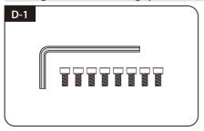
Teile erforderlich, Inbusschlüssel und acht (8) der M6 × 15 Bolzen
