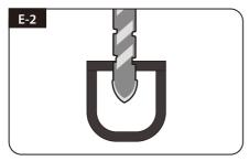
Bohren Sie ein 20mm Loch (oder größer) in der Mitte des Bandes Markierungs
