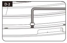
Legen Sie das Antenne auf der Montageplatte und fest anziehen jeder der Bolzen mit Inbusschlüssel
