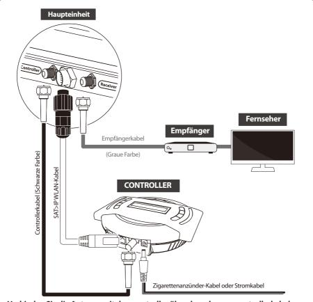
Verbinden Sie die Antenne mit dem controller über das schwarze controllerkabel. Beim Anschließen müssen Sie auf die Beschriftung und die Farbe der Kabel achten, weil die beiden Kabel die gleiche Form aufweisen.
