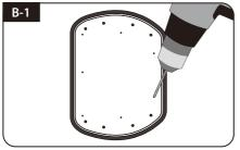
Platzieren Sie das Montageplatte auf der Silikon, und machen 7 Bohrungen (2 mm) mit einer Bohrmaschine
